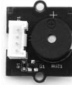
Figure 8 : Photographies d'un écran LCD d'après https://wiki.seeedstudio.com/Grove-LCD_RGB_Backlight/ et d'un avertisseur sonore (« buzzer ») d'après wiki.seeedstudio.com/Grove-Buzzer/
