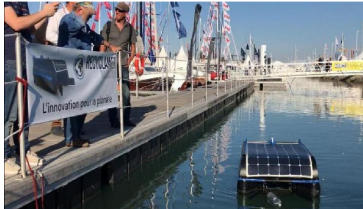
Document 10 : Photographie du petit robot Geneseas , collectant les déchets à la surface de l'eau, dans le port de La Rochelle. (Source : https://plastics-themag.com/Recyclamer-the-aquatic-vacuum )
